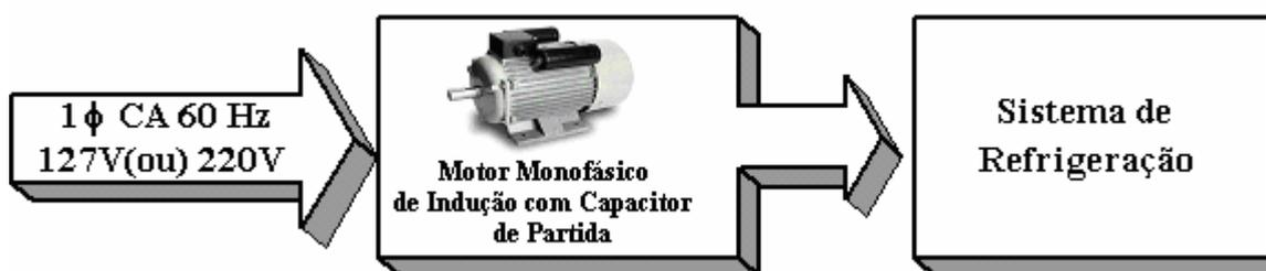
Figura 1.4 – Sistema de refrigeração convencional.
