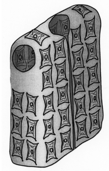
Figura 2.1: Desenho esquemático de uma vestimenta com diversos IMCCs ( Integrated mesoscopic cooler circuits ) anexados, descrito por Shannon et al. (1999).
