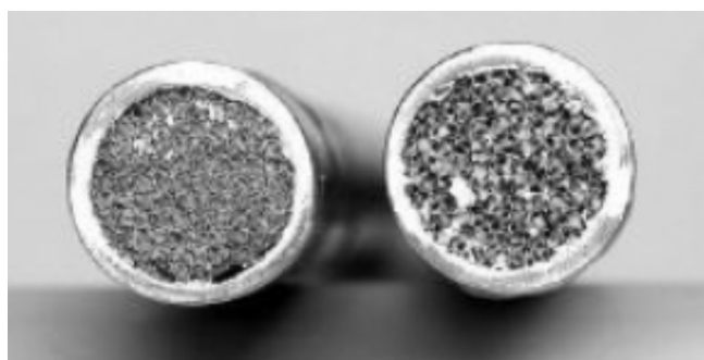
Figura 2.6: Exemplos de amostras de meios porosos metálicos usadas no trabalho de Haack et al. (2000).
