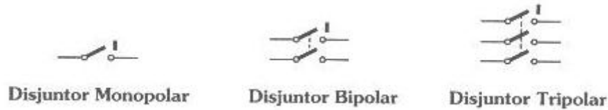
Figura 11: Símbolos elétricos do disjuntor
