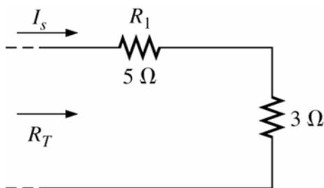
Figura 5 – Cálculo de  $R_T$  e  $I_S$  do circuito da Figura 3.
