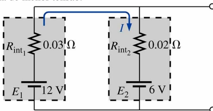
Figura 11 – Baterias de tensões diferentes em paralelo.
