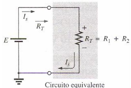
Figura 3 – Resistência total ou equivalente.
