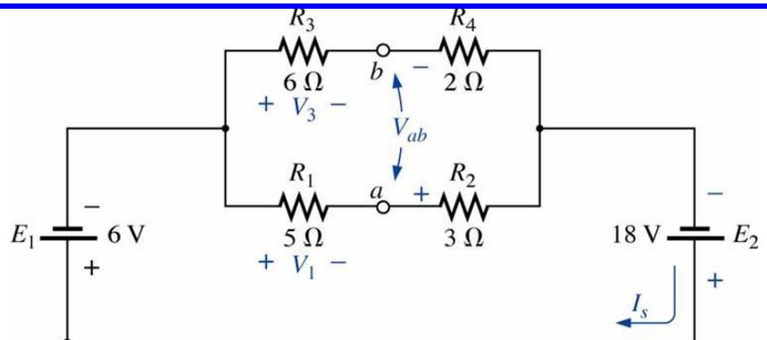
A tensão da fonte resultante da combinação é dada pela diferença entre as tensões das fontes originais, tendo a polaridade da fonte de maior tensão.
