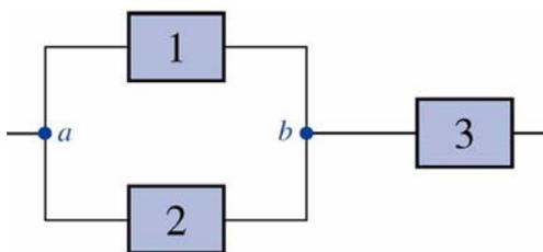
Figura 3 – Circuito onde 1 e 2 estão em paralelo e 3 está em série com a ligação em paralelo formada por 1 e 2.
