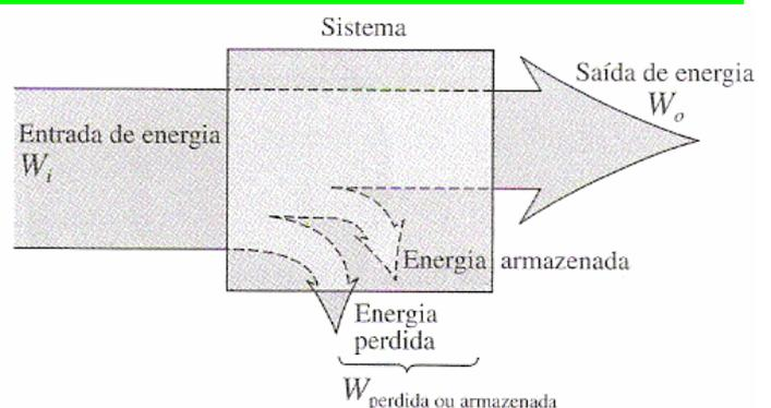
Figura 5 – Fluxo de energia em um sistema.
