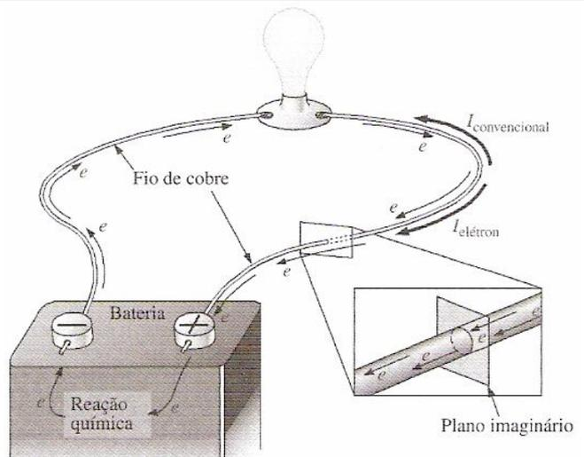
**Figura 6 – Circuito elétrico básico.**
