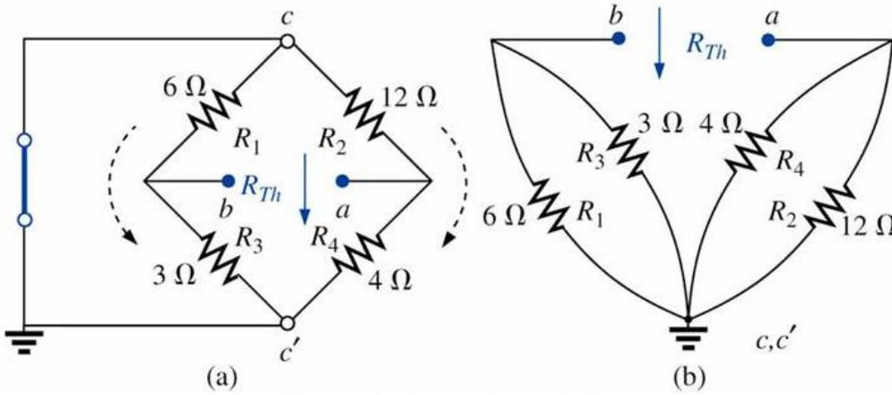
Figura 19 – Determinação de  $R_{Th}$ .
