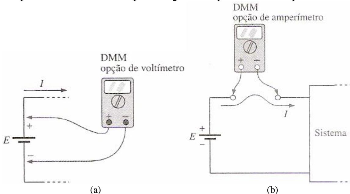
Figura 9 – Ligação de (a) um voltímetro e (b) um amperímetro para obter uma leitura positiva.
