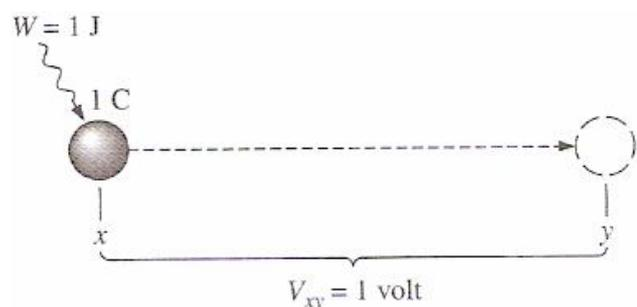
Figura 7 – Definição da unidade de medida de tensão elétrica.
