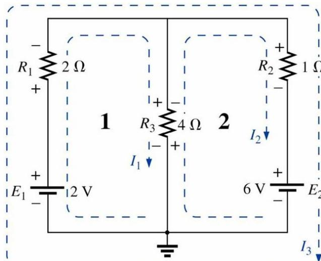
Figura 3 – Definindo as correntes de malha para um circuito de ‘duas janelas’.
