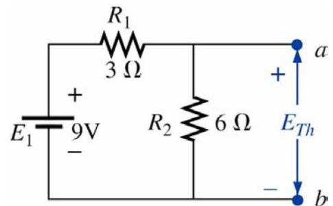
Figura 15 – Determinação de  $E_{Th}$ .
