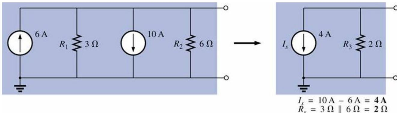
6. Reduza o circuito da figura abaixo a uma fonte única e calcule a corrente através de  $R_L$ .
