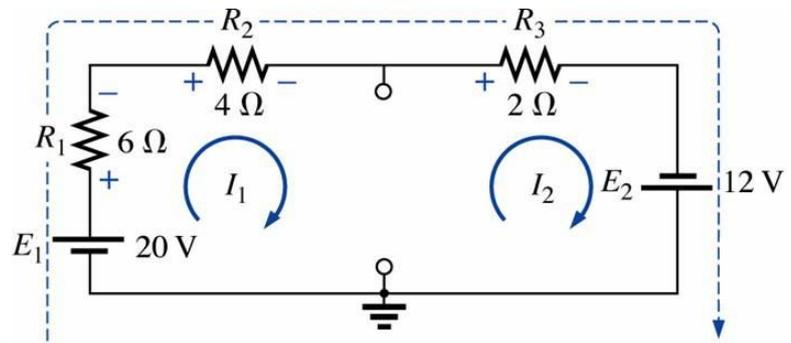
3. Aplica-se a LKT a todos os caminhos independentes restantes do circuito, usando as correntes de malha previamente definidas. Qualquer caminho resultante, incluindo duas ou mais correntes de malha, é definido como caminho de uma corrente de supermalha.
