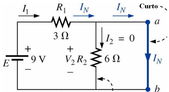
Figura 33 – Determinação de  $I_N$ .
