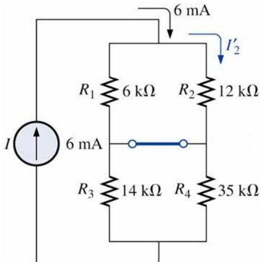
Figura 8 – Efeito da fonte de tensão sobre a corrente  $I_2$ .
