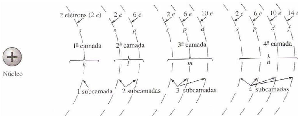
Figura 2 – Representação das camadas e subcamadas (níveis e subníveis) da estrutura atômica.
