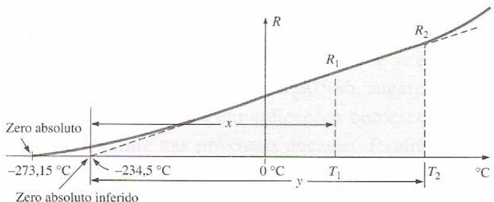
Figura 2 – Efeito da temperatura sobre a resistência do cobre.
