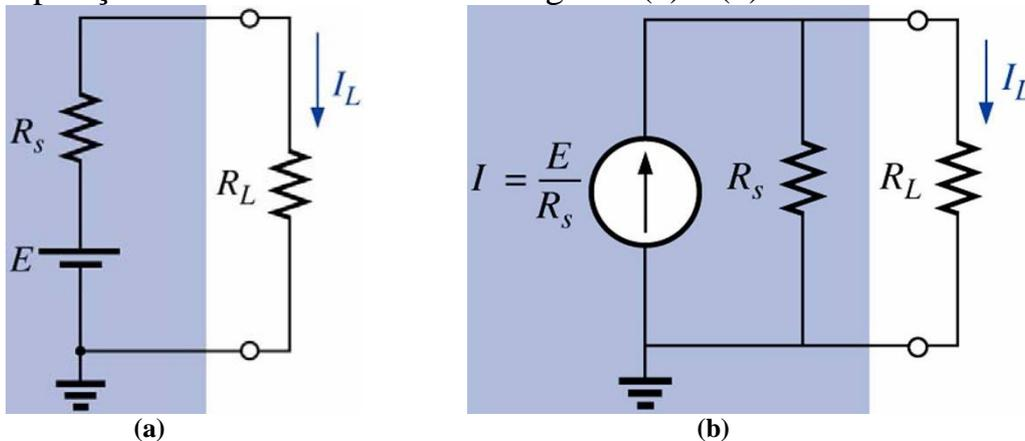
Figura 1 – (a) Fonte de tensão real; (b) fonte de corrente real.
