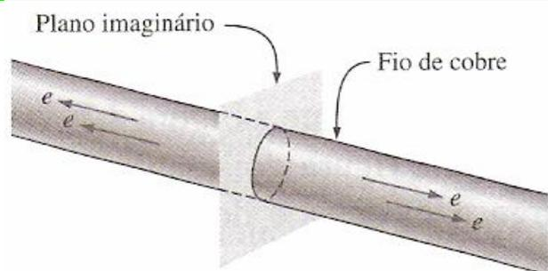
Figura 4 – Movimento aleatório de elétrons em um fio de cobre quando não existe tensão aplicada.
