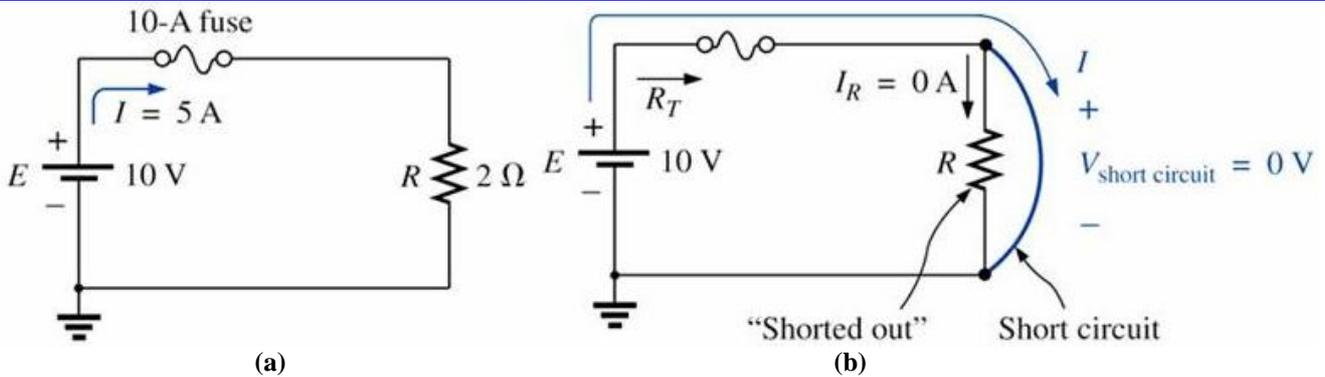
Figura 13 – Efeito de um curto-circuito nos níveis de corrente.
