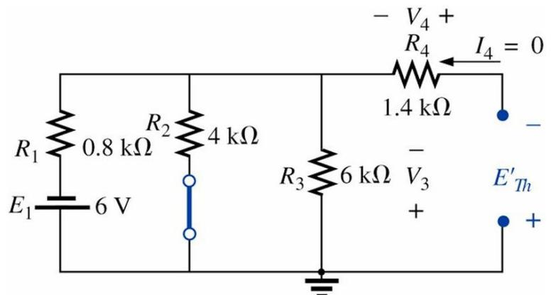
Figura 25 – Contribuição da tensão  $E_1$  para  $E_{Th}$ .
