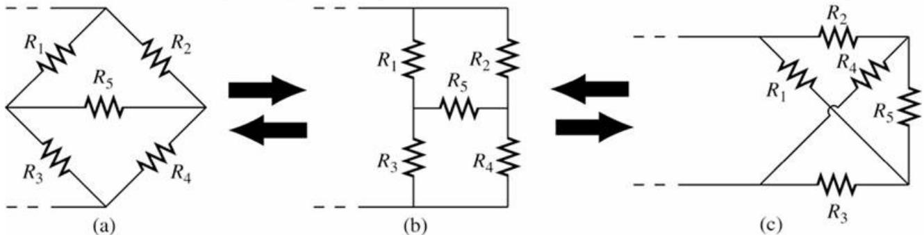
Figura 4 – Vários formatos para um circuito em ponte.
