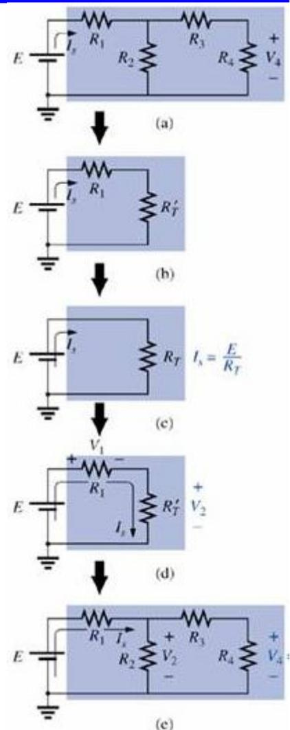
Figura 1 – Método de redução e retorno.
