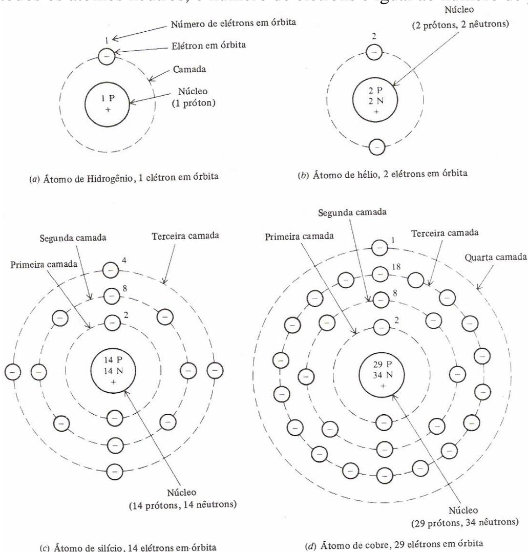
**Figura 1 – Estrutura atômica de quatro elementos comuns.**
