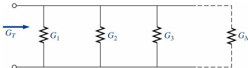
Figura 5 – Determinação da condutância total para circuito em paralelo.
