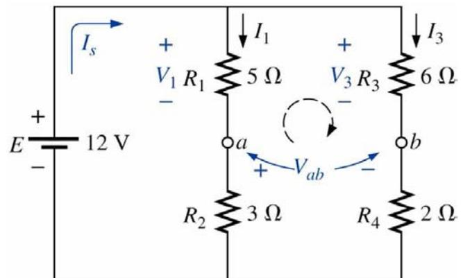
A tensão de circuito aberto  $V_{ab}$  é determinada aplicando a LKT à malha indicada na figura acima, seguindo o sentido indicado a partir de a:
