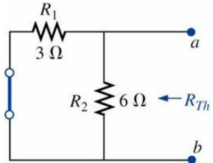
Figura 14 – Determinação de  $R_{Th}$ .
