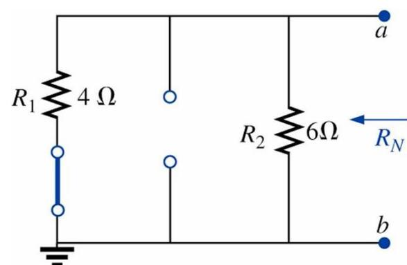
Figura 38 – Determinação de  $R_N$ .
