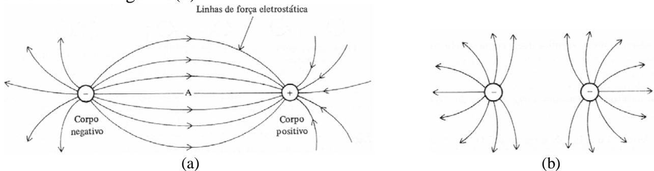
Figura 3 – O campo eletrostático entre cargas de polaridade (a) opostas e (b) iguais.
