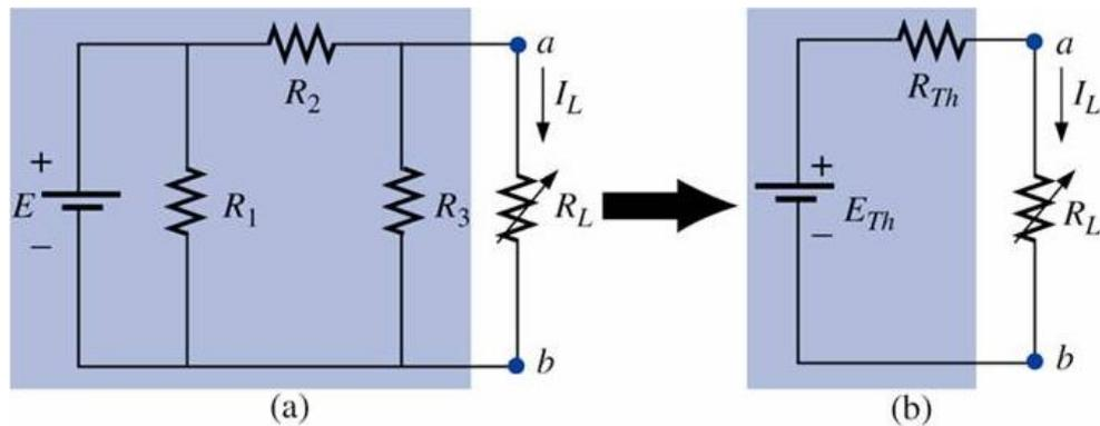
Figura 11 – Substituição de um circuito complexo pelo circuito equivalente de Thévenin.
