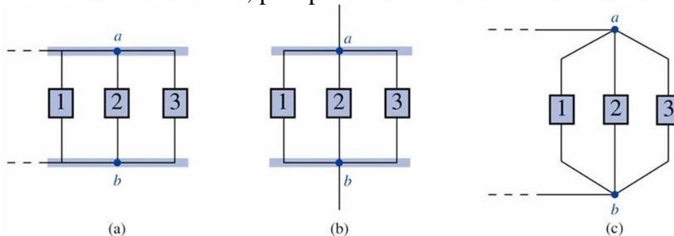
Figura 2 – Configurações com três elementos em paralelo.
