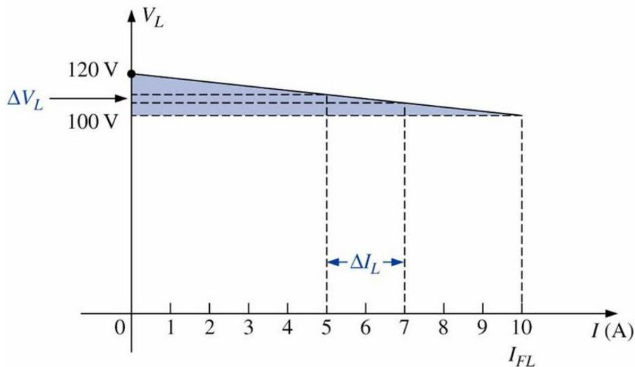
Figura 10 – Gráfico da tensão de saída  $V_L$  em função da corrente para um gerador CC com uma resistência interna de  $2 \Omega$ .
