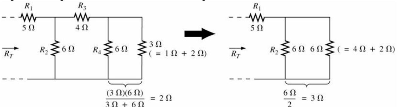
Figura 4 – Aplicação do método 1 para resolver o circuito da Figura 3.
