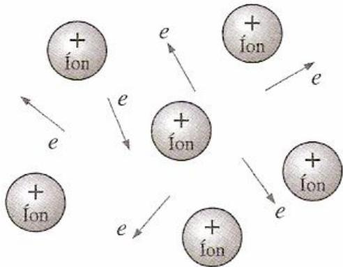
**Figura 5 – Movimento aleatório de elétrons livres em uma estrutura atômica**
