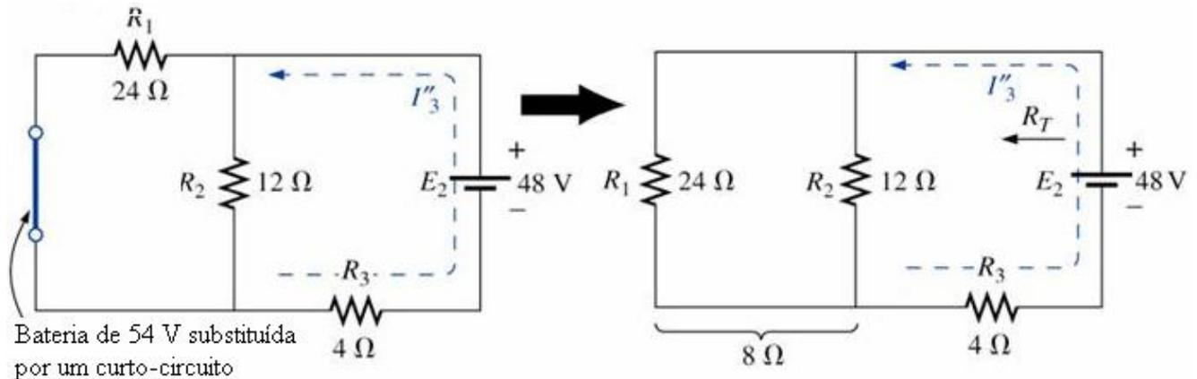
Figura 6 – Efeito de  $E_2$  sobre a corrente  $I_3$ .
