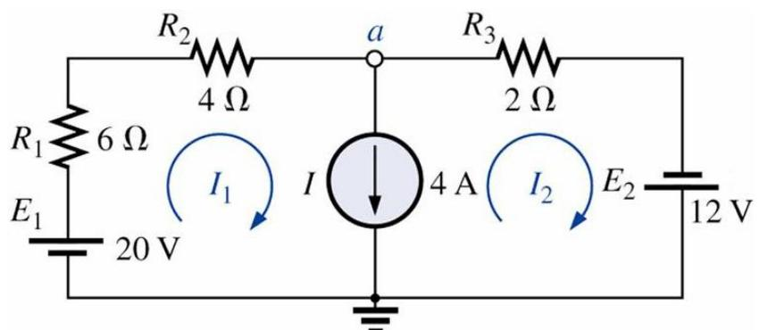
2. Redesenha-se o circuito substituindo-se as fontes de corrente por circuitos abertos.
