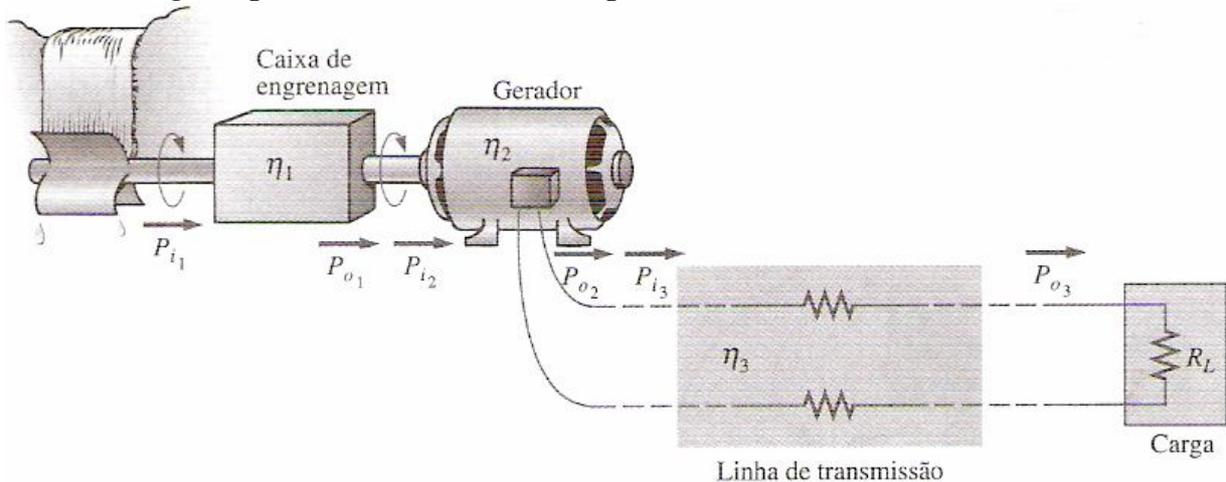
Figura 6 – Componentes básicos de um sistema de geração de energia elétrica
