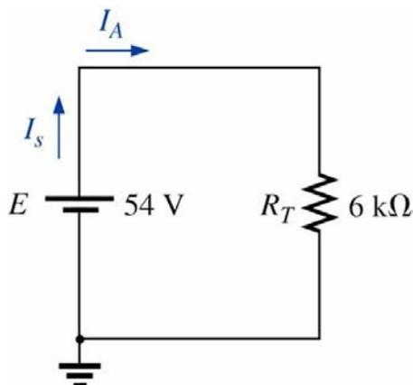
O resultado é um circuito equivalente, como visto na figura abaixo. Agora é possível determinar a corrente fornecida pela fonte,  $I_S$ , ao circuito.
