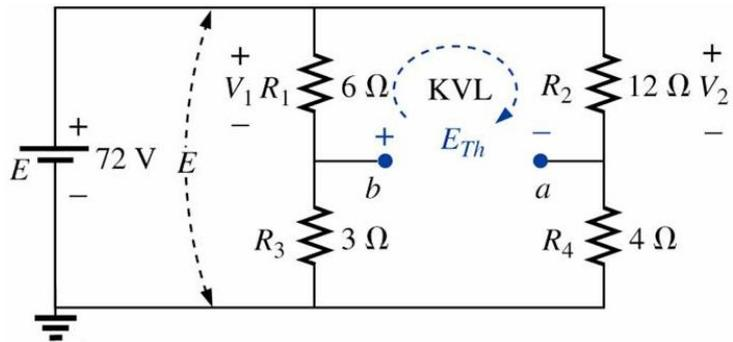
Figura 20 – Determinação de  $E_{Th}$ .
