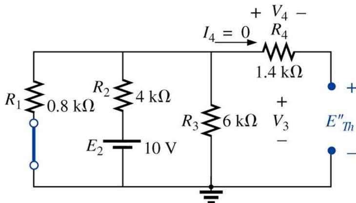
Figura 26 – Contribuição da tensão  $E_2$  para  $E_{Th}$ .
