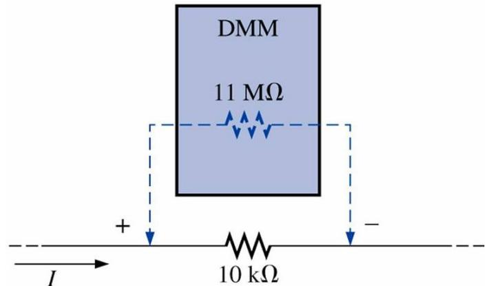
Figura 14 – Efeito da carga de um voltímetro.
