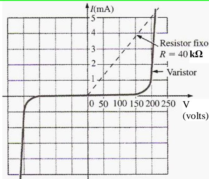
Figura 3 – Curva típica de um varistor.
