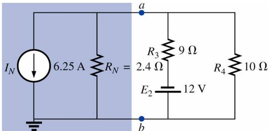
Figura 41 – Circuito equivalente de Norton.
