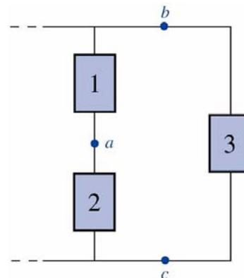
Figura 4 – Circuito onde 1 e 2 estão em série e 3 está em paralelo com a ligação em série formada por 1 e 2.
