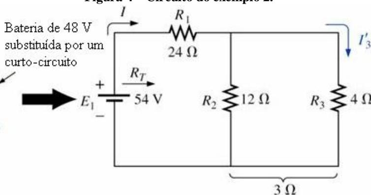
Figura 5 – Efeito de  $E_1$  sobre a corrente  $I_3$ .
