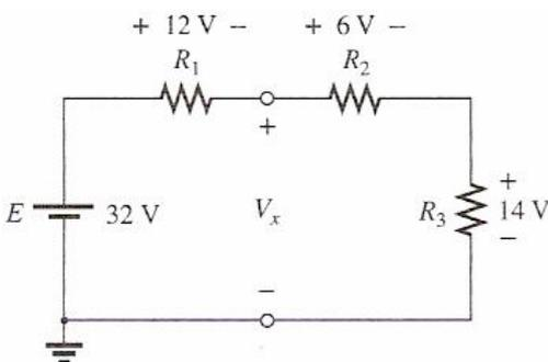
2. Determine a tensão  $V_x$  no circuito ao lado.
