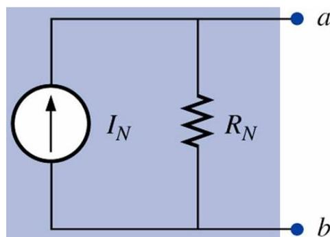
Figura 28 – O circuito equivalente de Norton.
