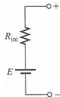
Figura 8 – Circuito equivalente de uma fonte de tensão CC.
