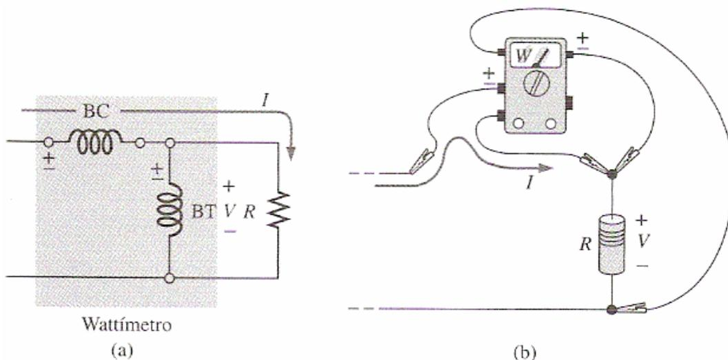
Figura 4 – Conexões de um wattímetro.
