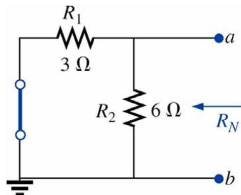
Figura 32 – Determinação de  $R_N$ .
