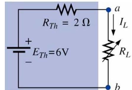
Figura 16 – Substituição do circuito externo a  $R_L$  pelo circuito equivalente de Thévenin.
