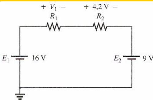
1. Determine a tensão  $V_1$  no circuito ao lado.
