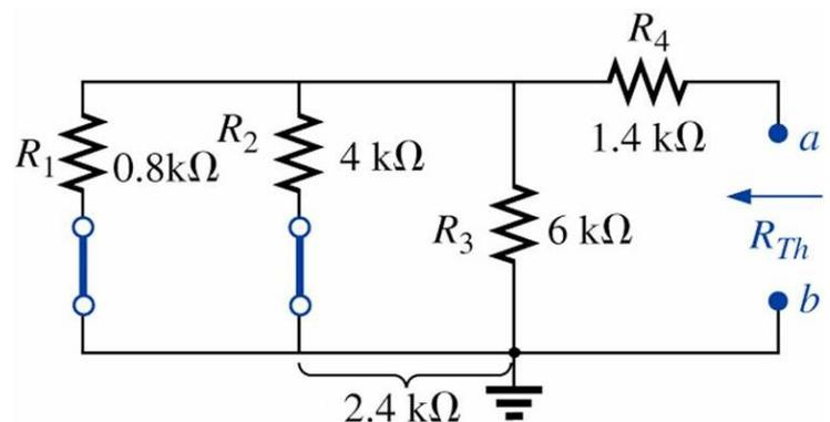
Figura 24 – Determinação de  $R_{Th}$ .
