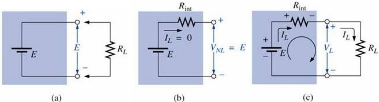
Figura 9 – Fonte de tensão (a) ideal  $R_{int} = 0$ ; (b) determinação de  $V_{NL}$ ; (c) determinação de  $R_{int}$ .
