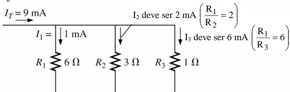
Figura 7 – Como a corrente se divide entre resistências em uma ligação em paralelo.
