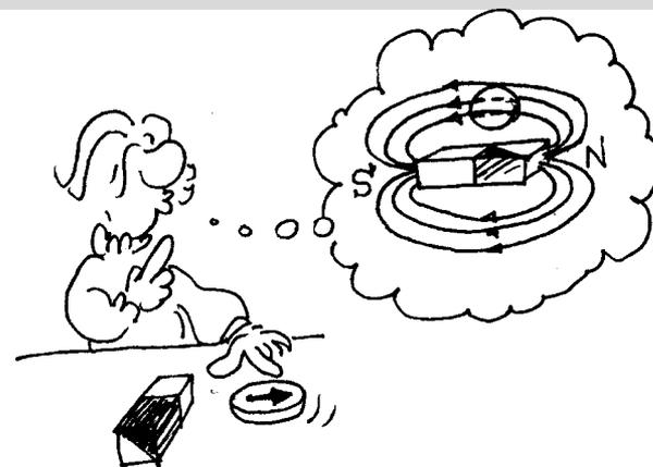
Isso nos permite entender porque a limalha de ferro, fica com um aspecto muito parecido quando é colocada nas proximidades de um pólo de um ímã e nas proximidades de uma bobina. Podemos agora entender fisicamente a origem
