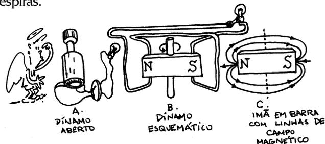
O campo magnético de um ímã parado varia de ponto para ponto do espaço, mas em cada um desses pontos ele permanece constante no tempo. Quando o ímã gira, como acontece com a parte móvel do dínamo de bicicleta o campo magnético varia no espaço ao redor dele. Essa variação gera um campo elétrico produzindo uma corrente elétrica que é percebida com o acendimento da lâmpada
