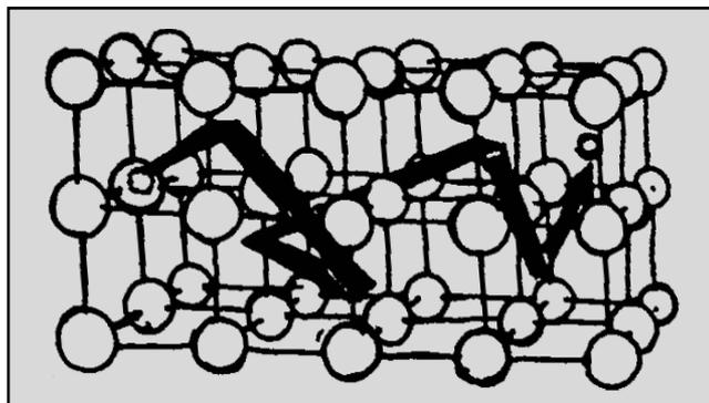
Do mesmo modo que o campo gravitacional age sobre uma massa, o campo elétrico produzido pela fonte agirá sobre todas as partículas eletricamente carregadas, presentes no fio, causando uma força elétrica sobre elas. Em particular ele agirá sobre os elétrons livres e, por isso, eles adquirirão um movimento adicional ao já existente que é o de agitação térmica.
