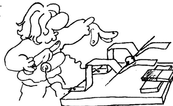
Para colocar o motor em funcionamento, não se esqueça que o esmalte do fio da bobina é isolante elétrico. Assim, você deve raspá-lo para que o contato elétrico seja possível. Além disso, em um dos lados você deve raspar só uma parte deixando uma parte ao longo do comprimento e não esqueça que esse motor precisa de um 'impulso' inicial para dar a partida.
