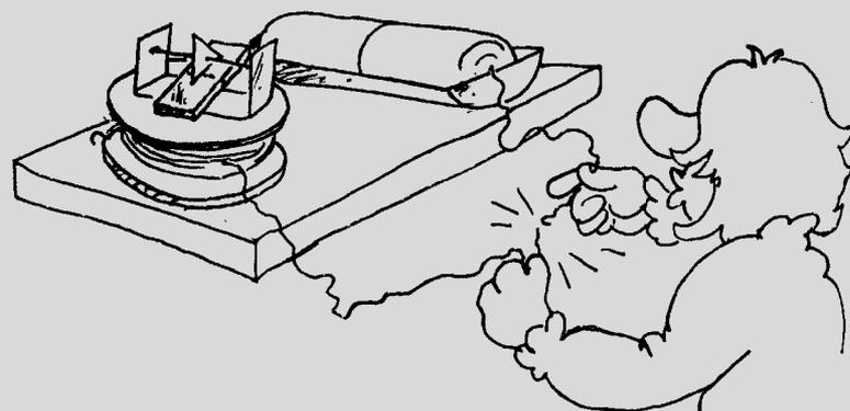
A produção de movimento nos medidores elétricos que utilizam ponteiro tem explicação semelhante a dos motores elétricos. O que difere um do outro é que nos motores a construção permite que o eixo dê voltas completas e isso não acontece nos medidores. A bobina, quando está com corrente elétrica cria um campo magnético na região onde se encontra o ímã. Este, da mesma forma que a agulha magnética de uma bússola, "sente" este campo e procura se alinhar a ele.
