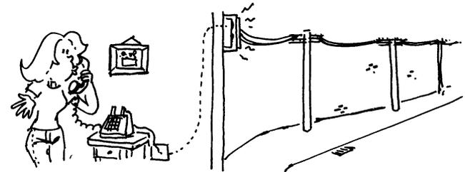
Tais circuitos elétricos também utilizam o poste como apoio mas não estão ligados aos circuitos residenciais e, por esse motivo, quando ocorre interrupção no fornecimento de energia, os telefones continuam funcionando.
