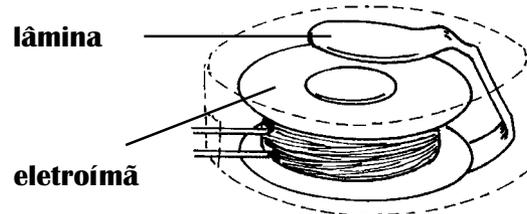
Próximo a ele existe uma lâmina de ferro, que é atraído quando existe uma corrente elétrica na bobina. Essa atração acontece porque a corrente elétrica na bobina cria um campo magnético na região próxima e imanta o ferro transformando-o em um ímã. Essa imantação existe apenas enquanto houver corrente elétrica na bobina. Daí esse conjunto ser entendido como um ímã elétrico.
