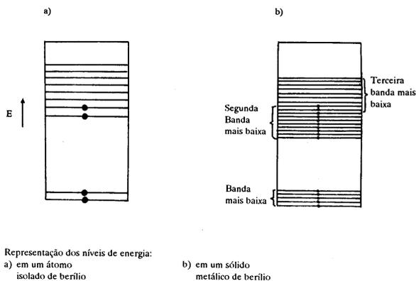
Nesta representação, cada linha horizontal representa um nível de energia possível para o elétron. E a linha com uma bolinha, representa a existência de um elétron neste nível assinalado.
