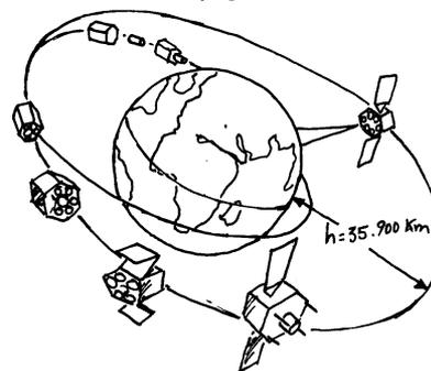
Eles recebem as mensagens e retransmitem para a Terra aos locais onde encontram-se as antenas das estações. A energia de um satélite é obtida com as baterias solares que cobrem as suas paredes externas. Quando ele encontra-se na parte na sombra da Terra ele é alimentado pelas baterias.
