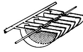
É justamente isso que fazemos quando mexemos no botão de sintonia do aparelho para localizar uma estação de rádio. Para ajustar a frequência do circuito oscilante do rádio com a da estação que desejamos sintonizar, alteramos a área de eletrização do capacitor, ao girarmos o respectivo botão.
