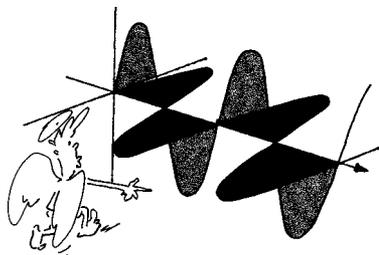
Esta é a representação do **campo eletromagnético**, incluindo a sua direção de propagação em uma única direção. Em torno de uma antena, o campo eletromagnético se propaga em todas as direções em torno dela.
