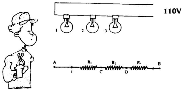
Na associação em série, cada lâmpada do circuito está submetida a uma tensão cuja soma equivale à tensão total entre os extremos A e B do circuito (uma vez que as perdas na fiação podem ser consideradas desprezíveis).
