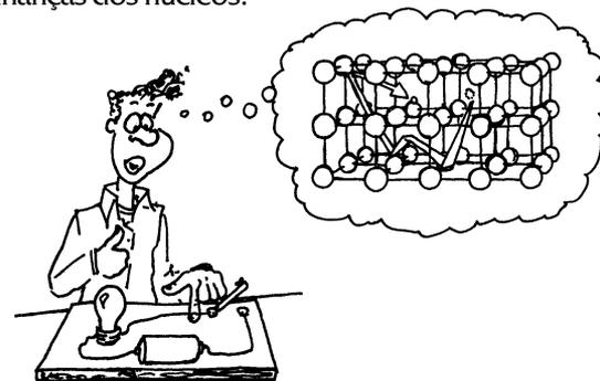
À temperatura ambiente tanto os elétrons quanto os núcleos atômicos estão em movimento cuja origem é térmica. Enquanto os núcleos vibram juntamente com os elétrons presos a ele, os elétrons que se desprenderam realizam um tipo de movimento que é aleatório pelo interior da rede cristalina.
