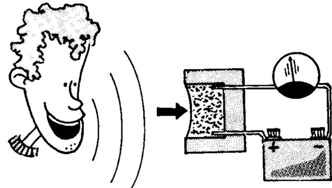
A corrente elétrica obtida no microfone, que representa o som transformado, é do tipo alternada e de baixa frequência. Assim, o som transformado em corrente elétrica pode ser representado conforme a figura a seguir.
