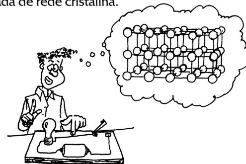
Além disso, no interior do metal, cada átomo perde um ou dois elétrons que ficam vagando pelos espaços vazios no interior do metal (sendo por isso chamados de elétrons livres, enquanto a maioria dos elétrons está presa nas vizinhanças dos núcleos).
