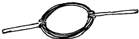
A bobina será apoiada em duas hastes feitas de metal, presilhas de pasta de cartolina, por exemplo, dando-lhes o formato indicado na figura e, posteriormente, encaixadas num pedaço de madeira.
