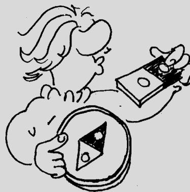
3. Coloque o ímã sobre uma folha de papel e aproxime a bússola até que sua ação se faça sentir. Anote o posicionamento da agulha, desenhando sobre o papel no local da bússola. Repita para várias posições.
