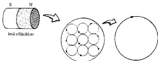
Assim, podemos pensar que o campo magnético criado pelo ímã deve-se à corrente elétrica em sua superfície. Em consequência, o ímã com formato em cilíndrico pode ser considerado como análogo a uma bobina com corrente elétrica no fio.
