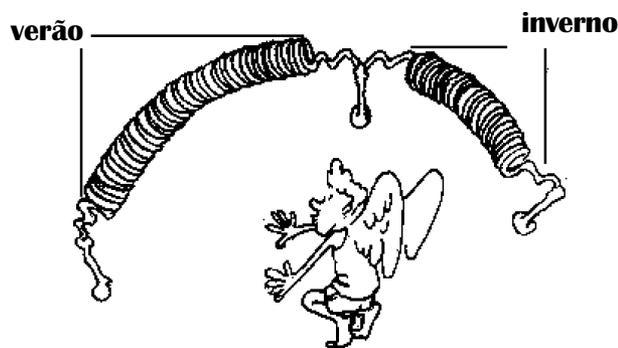
Alguns fabricantes usam para o verão todo o comprimento do resistor e um dos pedaços para o inverno.
