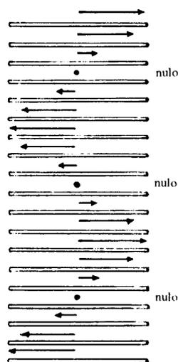
Como essa variação se repete ao longo do tempo, tanto o campo elétrico gerado pela usina como a corrente elétrica no circuito recebem a denominação de alternado(a).
