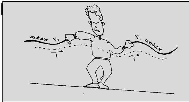
Uma maneira de se evitar os choques elétricos é fazer a ligação dos aparelhos à terra. O "fio terra" é feito enterrando-se, no local da instalação, uma barra de cobre em local úmido, para garantir alta condutividade elétrica entre os condutores e a terra.
