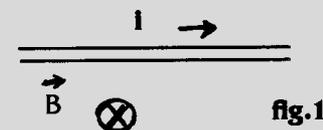
a. força sobre um fio com corrente elétrica para a direita e campo magnético entrando no plano do papel. (fig. 1)
