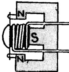
bobina que está sob ação de um campo magnético produzido por um ímã permanente. Nesse caso, com o movimento, surge na bobina uma corrente elétrica induzida devida à força magnética, que atua sobre os elétrons livres do condutor.
