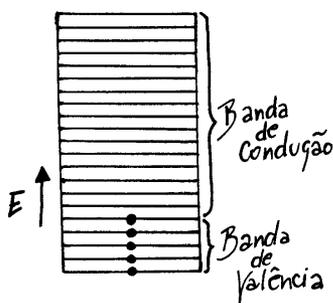
suficiente para que seus elétrons passem para os níveis de energia mais afastados. Por isso, estes materiais são caracterizados como condutores elétricos.
