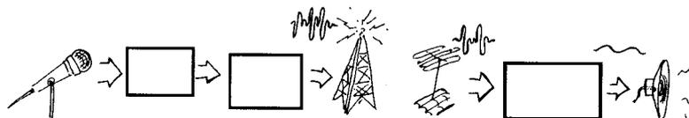
Posteriormente, esta corrente elétrica acionará um alto falante, se ela corresponder a um som, ou a um canhão eletrônico se tal corrente corresponder a uma imagem.
