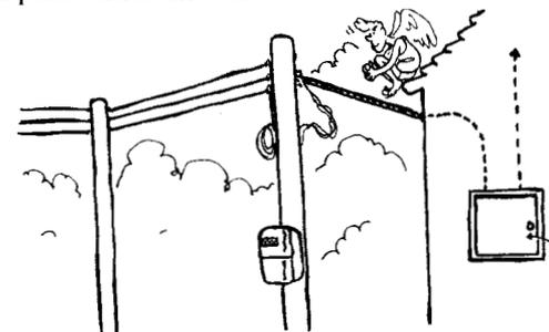
A chave geral serve como interruptor de toda a instalação elétrica, quando desligada os aparelhos não funcionam, isso facilita o manuseio na instalação e até pequenos reparos.
