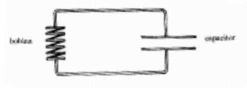
A bobina é um fio condutor enrolado em forma de espiral e o capacitor é constituído de duas placas condutoras, separadas por um material isolante e representado no circuito pelo símbolo ( ). Os dois traços verticais representam as placas separadas pelo isolante.
