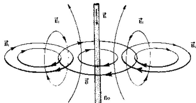
Pelo fato destes campos estarem indivisivelmente ligados entre si, eles recebem o nome de **campo eletromagnético**, o campo total formado por eles. Este campo, propaga-se para o espaço em todas as direções, a partir do circuito da antena, com uma velocidade de 300.000 km/seg.
