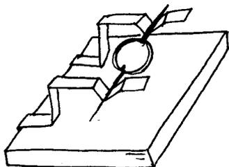
A parte fixa do motor será constituída de um ímã permanente que será colocado sobre a tábua, conforme indica a figura. Dependendo do ímã utilizado será necessário usar um pequeno suporte para aproximá-lo da bobina.
