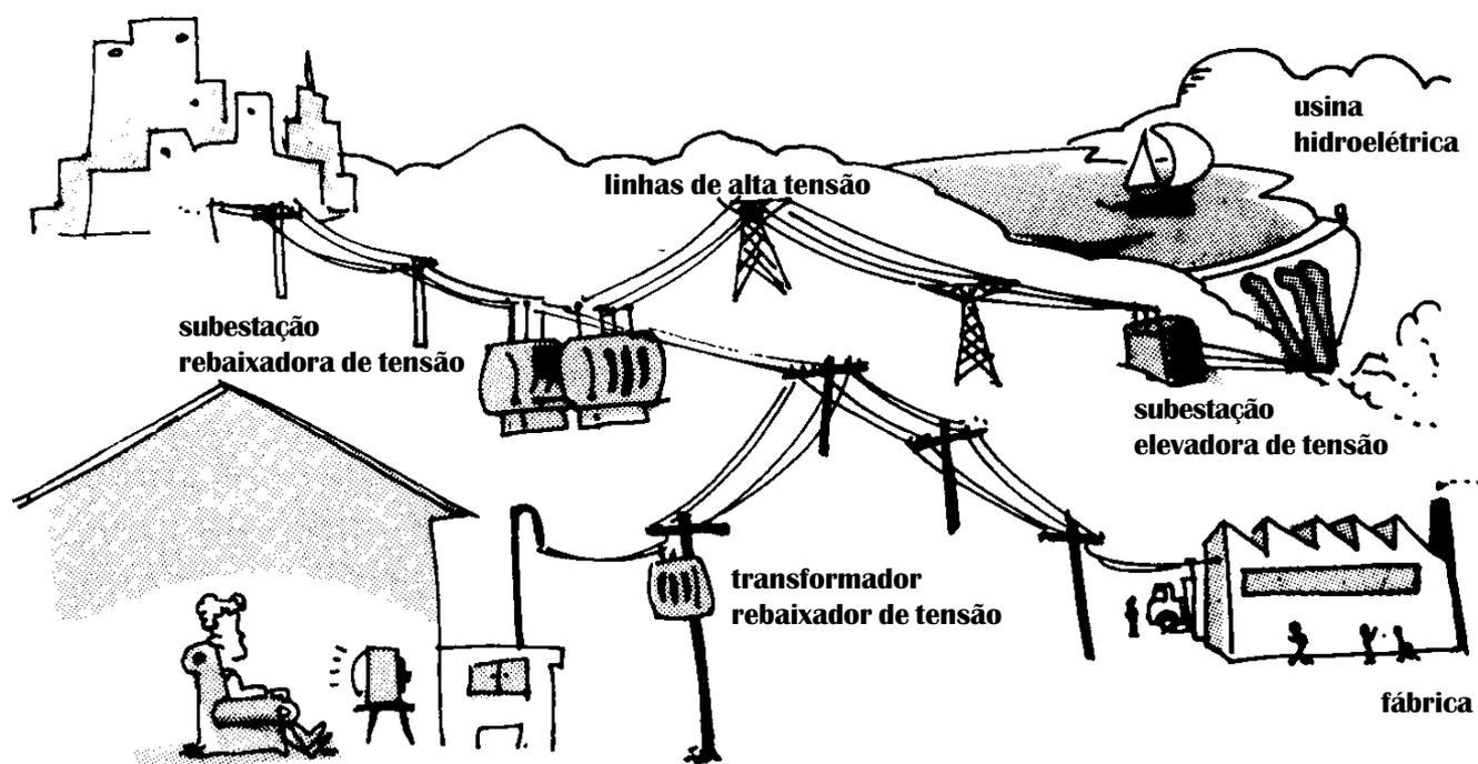
A transmissão da energia elétrica das usinas até os pontos de consumo é efetuada através de fios condutores e por isso parte dela é dissipada na forma de calor. De acordo com a lei de Joule-Lenz ( $P = R \cdot i^2$ ), essa perda é proporcional ao quadrado da corrente. Dessa forma, para reduzi-la é conveniente diminuirmos a intensidade da corrente. Como a potência é proporcional à tensão e à corrente ( $P = U \cdot i$ ), podemos obter a mesma quantidade de energia
