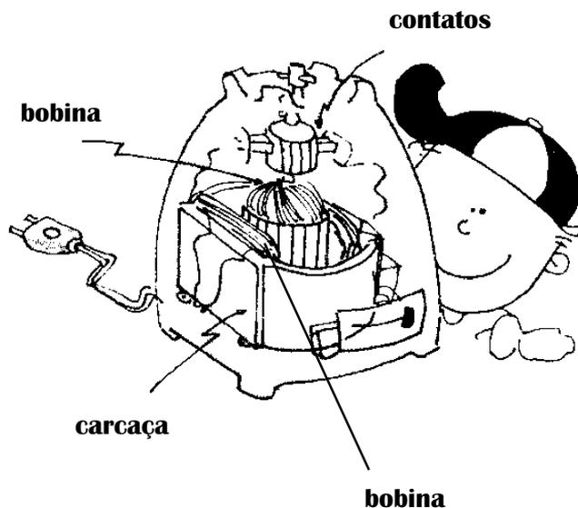
Quando um motor desse tipo é colocado em funcionamento passa a existir corrente elétrica nas bobinas presas à carcaça e também em uma das bobinas fixas no eixo. Cada uma delas cria na região um campo magnético. As duas primeiras têm a função de criar um campo magnético na região onde se encontra o eixo. A bobina com corrente fixada ao eixo vai "sentir" esse campo magnético, isto é, sobre ela vai atuar a força magnética e por isso ela gira junto com o eixo.
