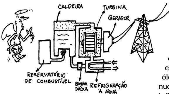
As turbinas podem também ser movimentadas por vapor d'água a alta pressão. Nesse caso, as usinas são termoeletricas ou nucleares.
