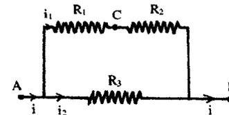
Nessa situação, a tensão U se aplica nos terminais da série  $R_1 + R_2$  e em  $R_3$ . Assim,  $L_3$  terá brilho maior que  $L_1$  e  $L_2$ . Em função dessa característica, esse tipo de circuito também não é empregado nas instalações elétricas residenciais mas é muito utilizado nos circuitos internos dos aparelhos eletrônicos como rádio, TV, comutadores, etc...
