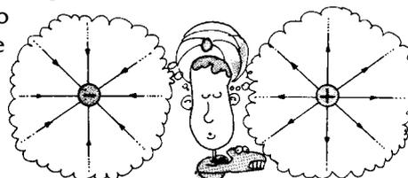
Quando uma outra carga elétrica  $q$  é colocada no campo elétrico criado por uma carga  $Q$ , o campo elétrico criado pela carga  $Q$  atua sobre a carga  $q$  exercendo nela uma força  $F$ .
