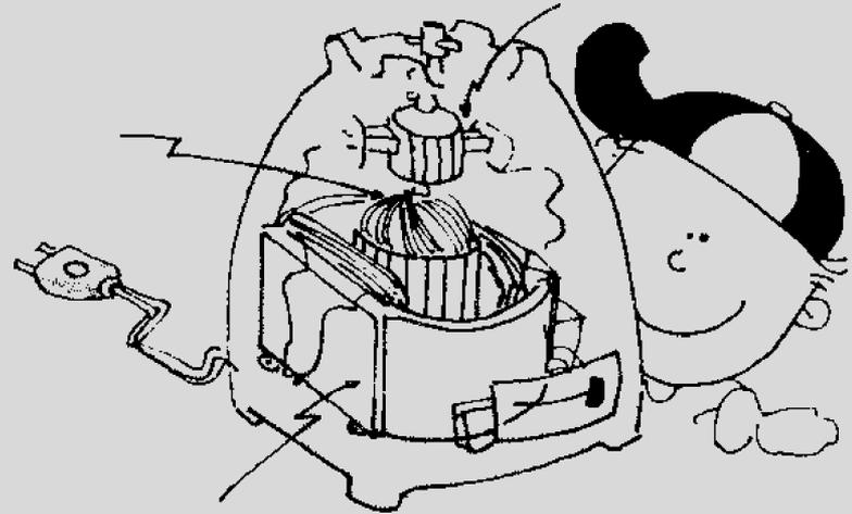
Nos motores elétricos, encontramos duas partes principais: uma fixa, que não se move quando ele entra em funcionamento e outra que, em geral, gira em torno de um eixo quando o motor é ligado.
