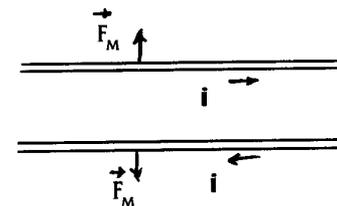
A atração ou a repulsão entre dois fios paralelos que tenham corrente elétrica elétrica tem a mesma natureza das atrações e repulsões entre ímãs. Isso porque ambos, fio com corrente elétrica e ímãs criam campo magnético no espaço ao redor.
