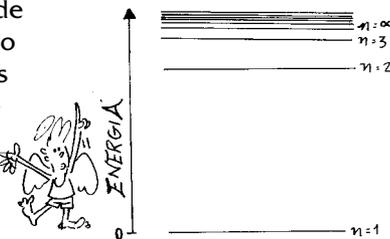
De acordo com este diagrama, quando o elétron encontra-se no nível energético 1, ele está no estado fundamental. Fora dele, o átomo está no estado excitado. Para separar o elétron do átomo, isto é, ionizá-lo, o elétron deve receber  $21,7 \cdot 10^{-19}$  J de energia.
