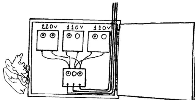
Os fusíveis são colocados somente nos fios energizados (fios fase). Não devemos colocar fusíveis nos contatos da chave por onde passa o fio neutro, pois, se ele queimar, o circuito ficará sem o neutro, e um aparelho ligado a este circuito não funcionará. Além disso, se uma pessoa tocar o aparelho, poderá levar um choque, conduzindo a corrente elétrica para a Terra.
