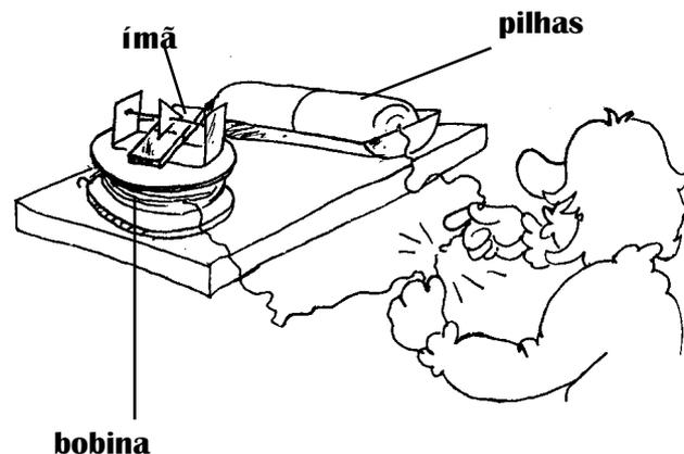
O ímã já criava um campo magnético na região onde se encontra a bobina e a partir do momento em que há corrente elétrica nela, tem início a interação entre eles. Ambos ficam sujeitos a uma força de natureza magnética e como a bobina está fixada ela não se move. Já o ímã entra em movimento e como ele está preso ao eixo, ele gira.
