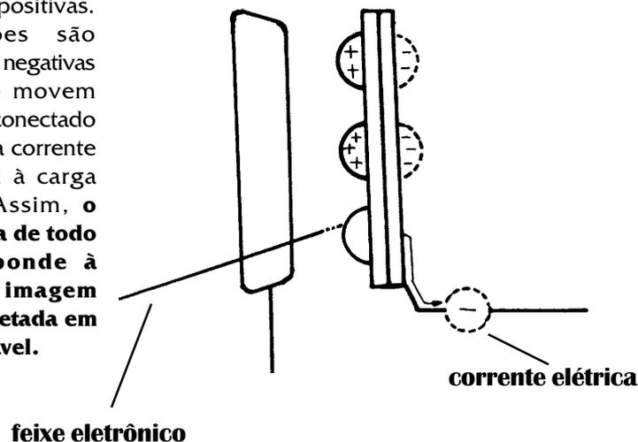
O feixe eletrônico é constituído de elétrons retirados de um filamento super aquecido, por um processo semelhante ao do tudo da TV: **efeito termoiônico**.
