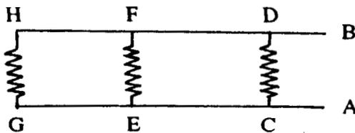
As correntes estabelecidas em cada uma delas será  $i_1, i_2, i_3$ , e a corrente total, estabelecida entre os pontos A e B do circuito, será  $i = i_1 + i_2 + i_3$ .
