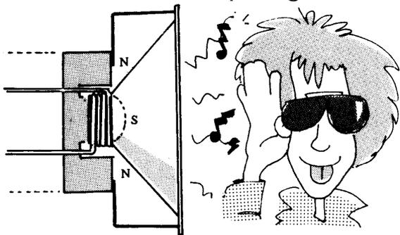
Como a bobina e o cone estão unidos quando ela entra em movimento, as vibrações mecânicas do cone se transferem para o ar, reconstituindo o som que atingiu o microfone.
