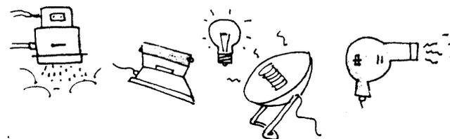
Todos eles tem em comum o fato de transformarem a energia elétrica fornecida por um fonte em energia térmica. Esses aparelhos são os que tem a construção mais simples: possuem um pedaço de fio em forma de espiral cujo nome é **resistor**.
