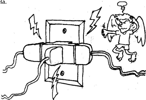
2. A espessura dos fios de ligação tem um papel importante. Nas instalações pode ocorrer perdas de energia, seja por aquecimento dos fios (efeito joule), fugas de corrente, etc, colocando em risco a segurança das pessoas e de toda a instalação.
