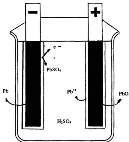
Quando os terminais da pilha ou bateria são ligados por algum material condutor e o circuito elétrico é fechado, uma corrente elétrica é estabelecida. Os elétrons livres do condutor adquirem um movimento de avanço do pólo negativo para o pólo positivo. O sentido da corrente não se altera no tempo. Por isso, a bateria e a pilha são fontes de corrente contínua.
