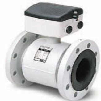
normalmente constituído por aço inoxidável. Os materiais do forro interior e os eletrodos são escolhidos em função do fluido a medir. Há dois eletrodos implantados no tubo de medida que fazem contato com o líquido. Perpendicularmente à linha dos eletrodos, é aplicado um campo magnético produzido por duas bobinas exteriores ao tubo de medida.
