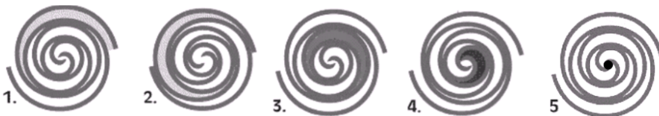
Figura 3.20: Processo de compressão em um compressor Scroll.
