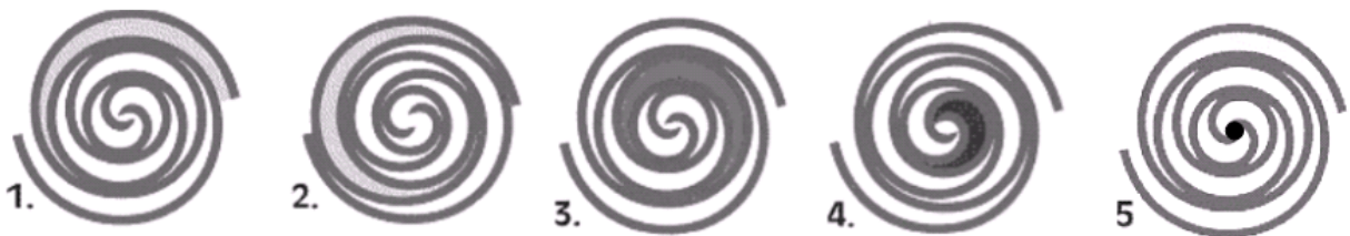
Figura 38 - Processo de compressão em um compressor Scroll
