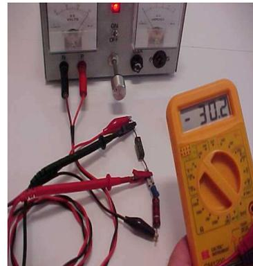
Montaje serie, de diodo y resistencia, aplicamos voltaje en los extremos y colocamos el polímetro en el diodo, polarización directa caen en el diodo 7,1 V en polarización inversa no conduce por lo que tendremos el voltaje aplicado, 30 V.
