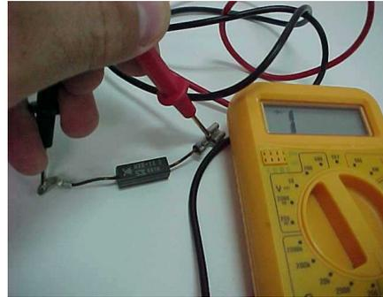
**Medida de infinito con polímetro digital, tanto en polarización directa como en polarización inversa, por lo que nos ayuda demasiado a determinar su estado real.**
