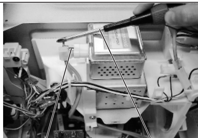
Terminal do filamento do magnetron Insulate handle screwdriver Toque primeiramente no chassi, então feche um curto-circuito com o terminal do filamento
