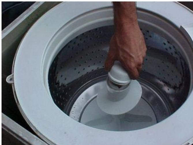
Retire o chapeuzinho do agitador. Dentro do agitador você vai ver um parafuso de 10mm. Você vai precisar de uma CHAVE L LOOOONGA. (eu utilizo uma L10mm que eu aqueci e desfiz o L e na outra extremidade eu uso uma Allem 10mm, assim eu criei minha chave longa.
