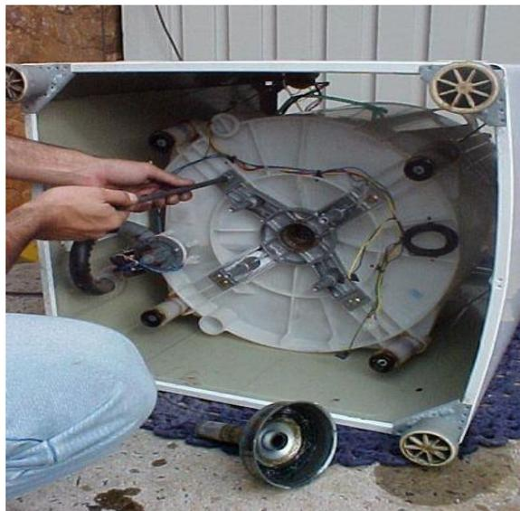
Na brastemp eletrônica de 7/8kg vc devesa soltar a base X e retirá-la fora para poder fazer a substituição do rolamento superior e do retentor.
