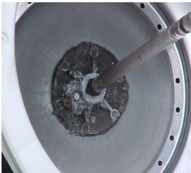
Faça uma limpeza na superfície do suporte do cesto, e veja que aparece o encaixe do tubo de centrifugação. Direcione a ferramenta bem em cima do encaixe (certifique-se de que o parafuso da cunha esteja solto e empurrado).
