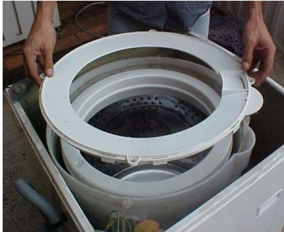
Retire a moldura superior do tanque, existem umas travinhas na lateral, é só puxar p/ fora e levantar.
