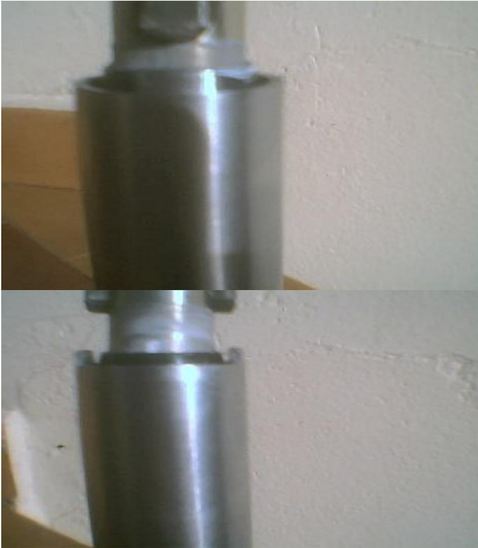
O ideal é ter o tubo de centrifugação na mão ao fazer a adaptação na ferramenta (eixo antigo), esmerilhar a trava até obter o diâmetro exato da parede externa do Tubo de centrifugação.
