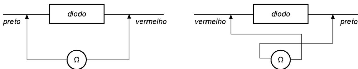
O diodo em boas condições deve apresentar em uma das medidas (ohmímetro em escala R x 10) baixa resistência e, ao inverter as pontas de prova, a outra medida deve apresentar alta resistência.
